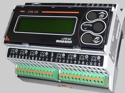
Le CML106 est une centrale d'acquisition destinée aux applications exigeantes en terme de précision, et de sécurité fonctionnelle, l'isolation galvanique complète du produit assure une indépendance totale de chaque voie de mesure.
